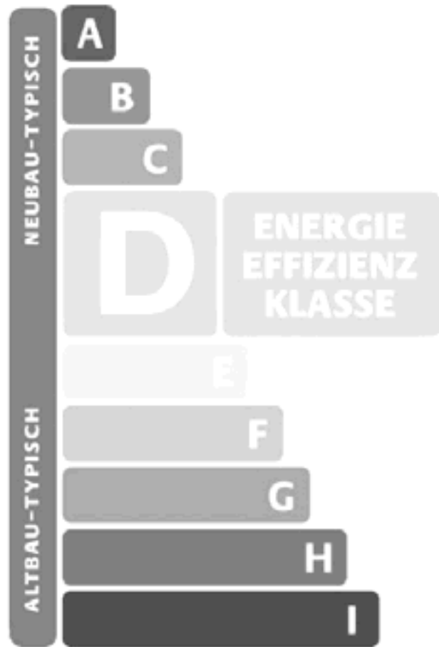
Entwurf des Wirtschaftsministeriums Luxemburg für ein Label, das Gebäude nach ihrer Energieeffizienz klassifiziert.
